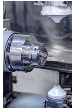
auf Rotierachse beim Drahterodieren
