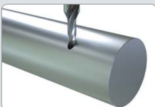
Exzentrische Bohrungen in konvexe Oberflächen.
