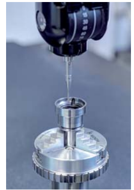
Werkstückfixierung auf Messmaschine
