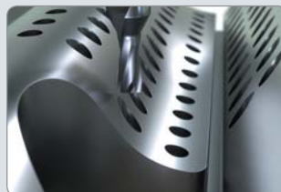
Bohrungen bis 60° Neigungswinkel in konvexe Oberflächen.
