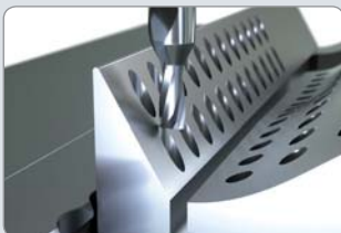
Bohrungen in bis zu 60° geneigte Oberflächen.
